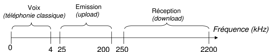
FIG. 4.3 – Exemple de multiplexage fréquentiel : signaux ADSL.
